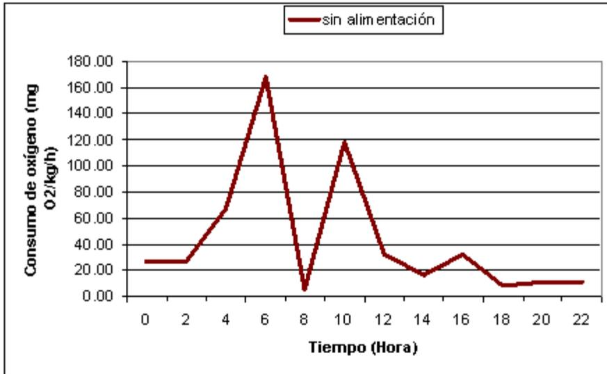
Figura 3: Evolución del consumo de oxígeno en mg O<sub>2</sub>/kg/h del control y una temperatura de 28° C
