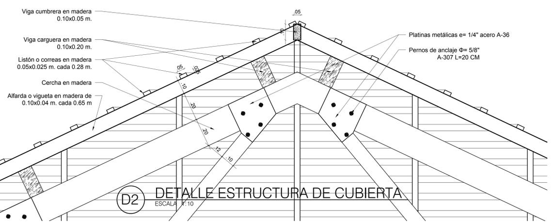
**D2 DETALLE ESTRUCTURA DE CUBIERTA**
